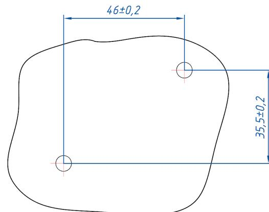
Рисунок 3.3 – Разметка для сверления отверстий
