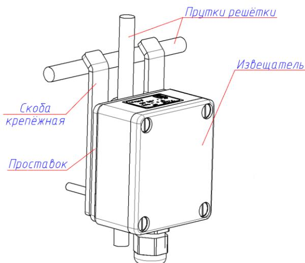
Рисунок 3.1 – Крепление извещателя на решётке из прутка
