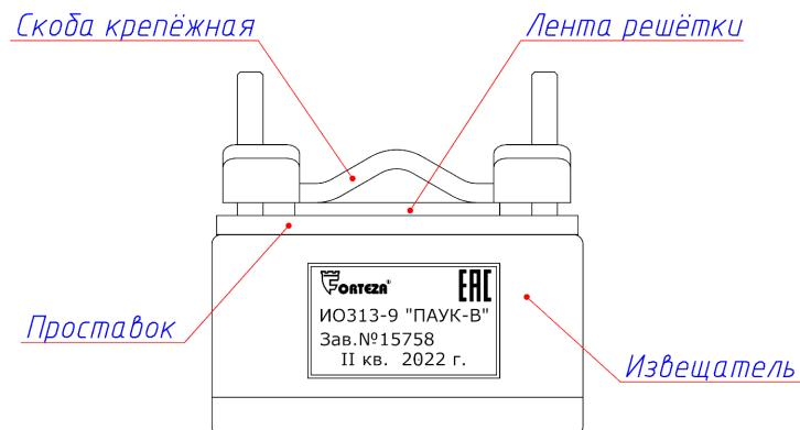
Рисунок 3.2 – Крепление извещателя на решётке из металлических лент
